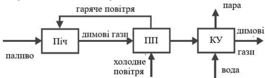
Рисунок 4.5 - Первинна схема включення повітропідігрівника і котла-утилізатора
