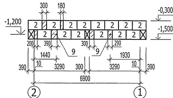
Схема расположения блоков в осях А-Б
