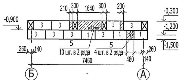
Схема расположения блоков в осях 1-2
