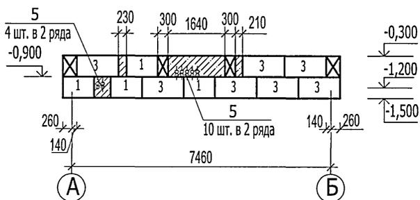
Схема расположения блоков в осях 2-1
