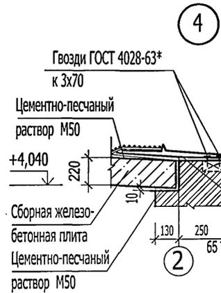
3 Гвозди ГОСТ 4028-63\* к 3x70 Кровельная оцинкованная сталь (ГОСТ 14918-80\*) Антисептированная пробка 80x120x120 через 510 Полоса 4x40, L=700 ГОСТ 103-76\*, шаг 750 Ковер водоизол. дополнительный один слой изопласта К Цементно-песчаный раствор М50
