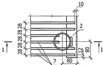
1. Патрубок для удаления масла приваривают над углубленной частью маслоприемника после установки решетки.
