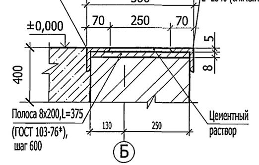
4 Гвозди ГОСТ 4028-63\* к 3x70 Цементно-песчаный раствор М50 Сборная железобетонная плита Цементно-песчаный раствор М50 Кровельная оцинкованная сталь (ГОСТ 14918-80\*) Антисептированная пробка 80x120x120 через 510 Полоса 4x40, L=960 (ГОСТ 103-76\*), шаг 750
