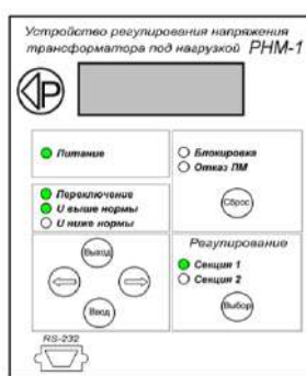
Рисунок 28. Блок автоматического регулирования положения РПН трансформатора.
