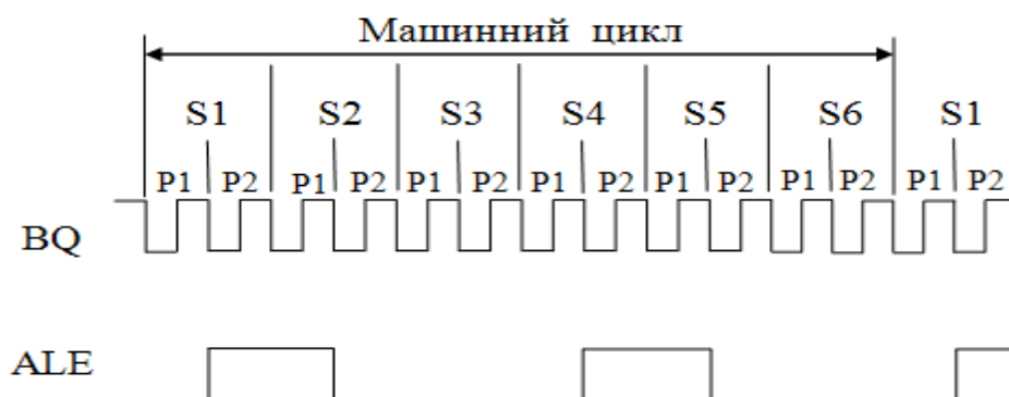
Рисунок 8.1 – Діаграма формування машинних циклів МК–ра
