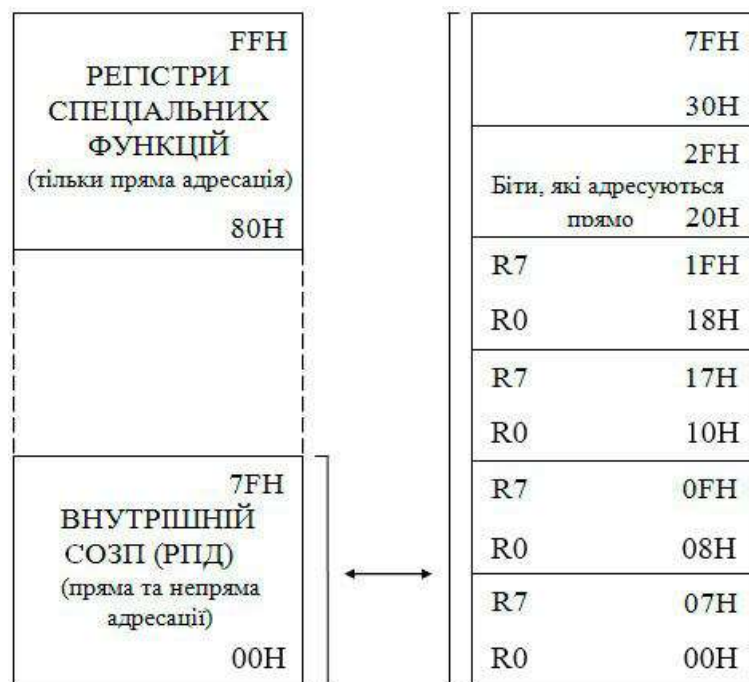
Рисунок 7.6 – Адресний простір внутрішньої статичної пам'яті даних (SRAM) та регістрів спеціальних функцій (PCФ)
