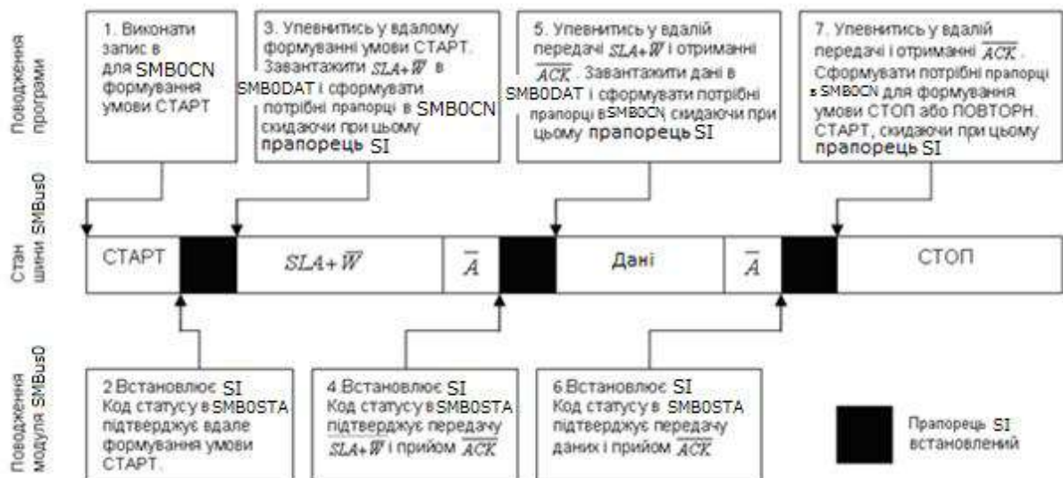
Рисунок 6.19 – Приклад взаємодії програми з модулем SMBus0
