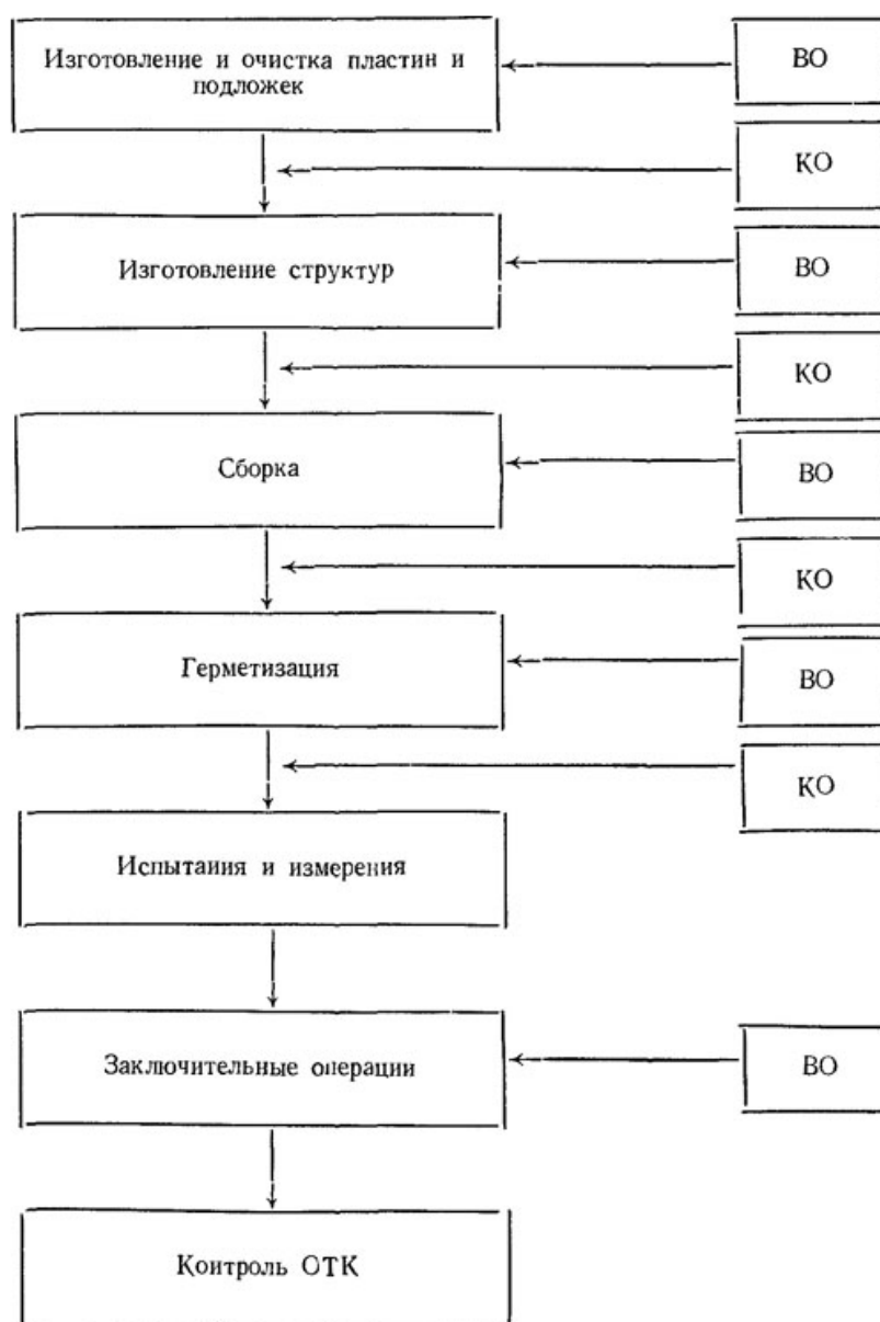
Рисунок 9.1. Общая схема изготовления интегральных микросхем: ВО – вспомогательные операции. КО – контрольные операции
