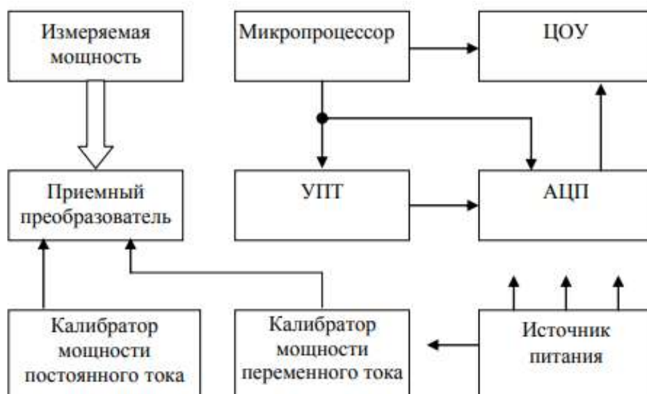
Рисунок 3.2.12. Упрощенная структурная схема цифрового ваттметра
