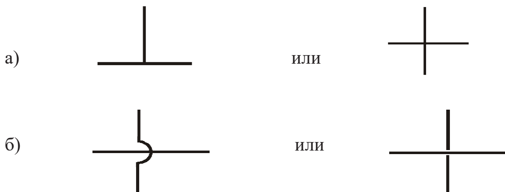
Рисунок 2.2. Соединения (А) и пересечения труб (Б)
