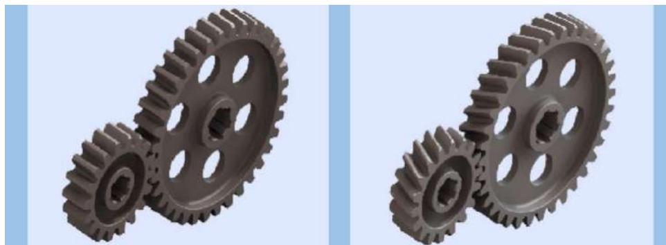
Рисунок 5.11. Зубчатые передачи (вертикальные и винтовые)
