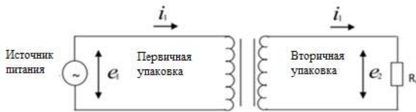
Рисунок 3.2. Схема подключения трансформатора
