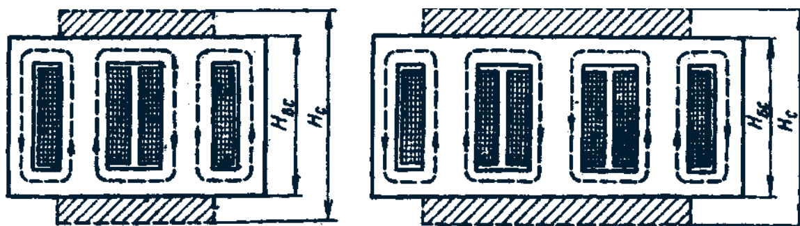
Рис. 4. Магнитопроводы бронестержневого трансформатора: однофазного (а); трехфазного (б)
