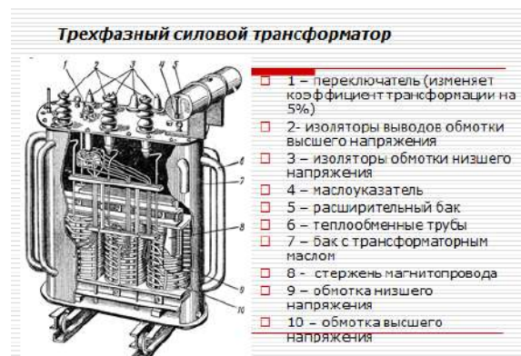
Рисунок 2.21 - Устройство силового трансформатора
