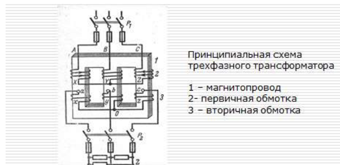
Рисунок 2.20 - Принципиальная схема трехфазного трансформатора
