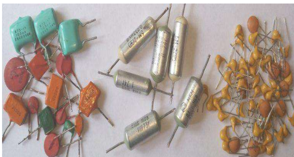
Рис 1.17 Конденсаторы постоянной емкости
