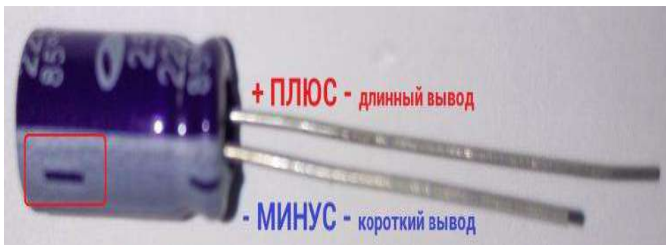
Рис 1.21 Обозначение выводов конденсатора
