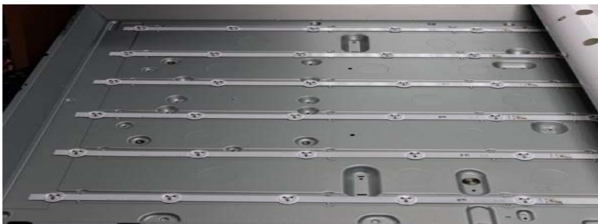
Рис. 8.10 расположение светодиодных планок внутри контейнера матрицы.
