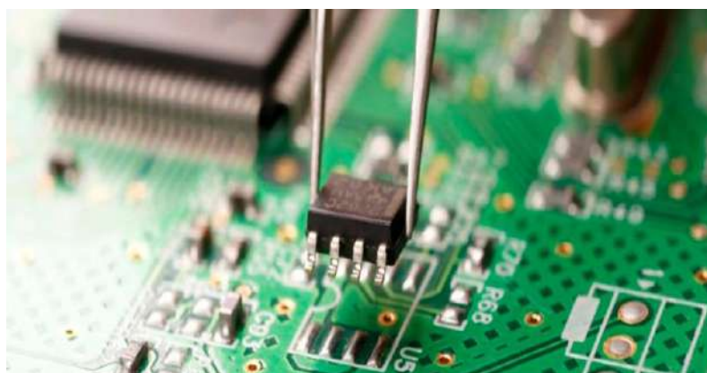
Рис.1.3 Поверхностный монтаж на печатную плату
