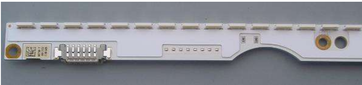
Рис. 8.12 Торцевая подсветка Edge LED
