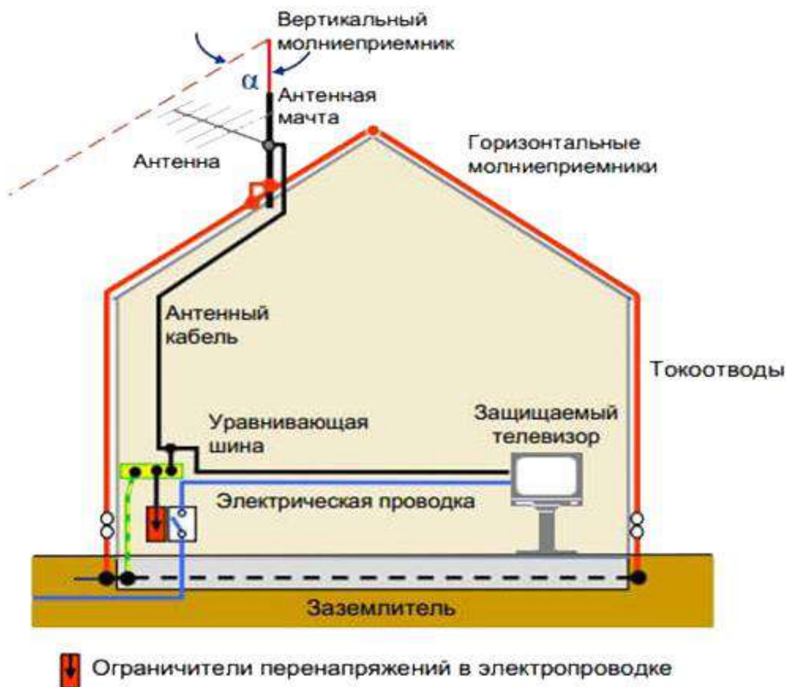
Рис. 7.19 Схема электрического соединения антенны
