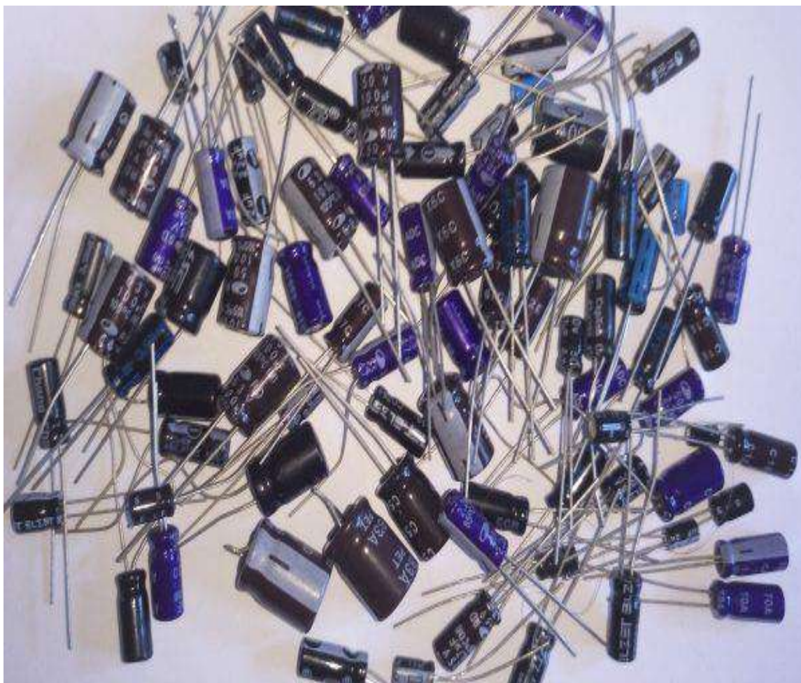
Рис 1.20 Электролитические конденсаторы
