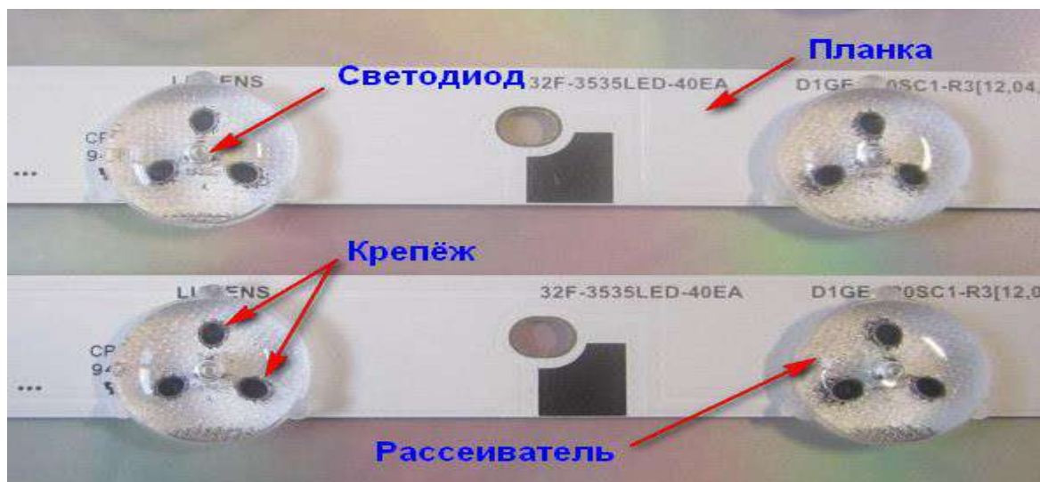
Рис. 8.9 расположение подсветки Direct LED
