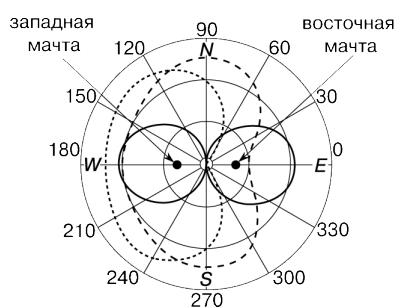
Рисунок 7.11 Диаграмма направленности антенн, разнесенных на \frac{1}{4} длины
