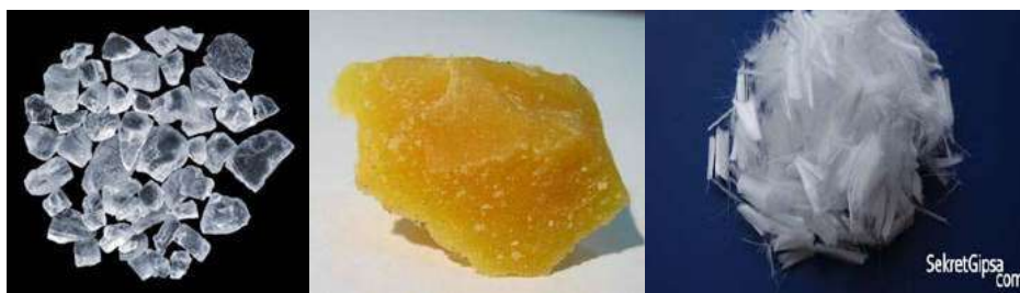
Рисунок 4-Примеры кристаллических (соль), аморфных (воск) и композитных твердых тел соответственно
