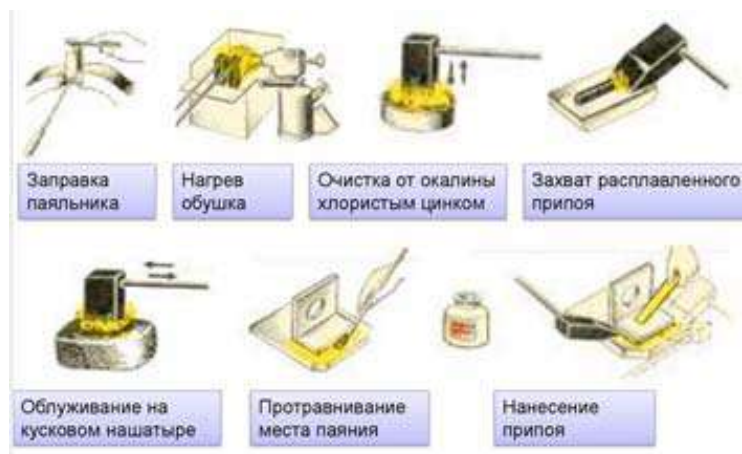
Рисунок 52-Пайка мягким припоем
