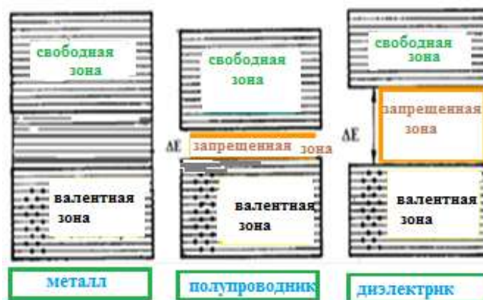
Рисунок 6- Распределение энергетических зон в кристалле твердого тела
