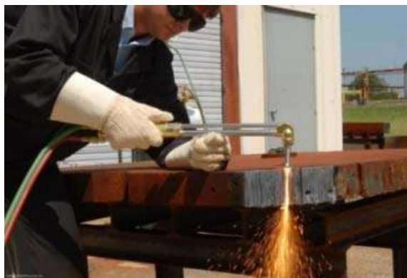
Рисунок 45- Газовая резка
