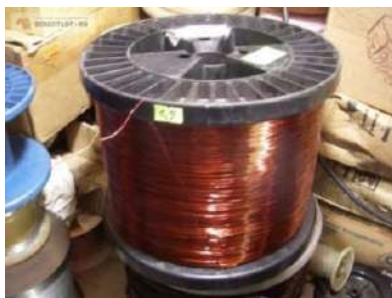
Рисунок 16- Жилы обмоточных проводов катушки
