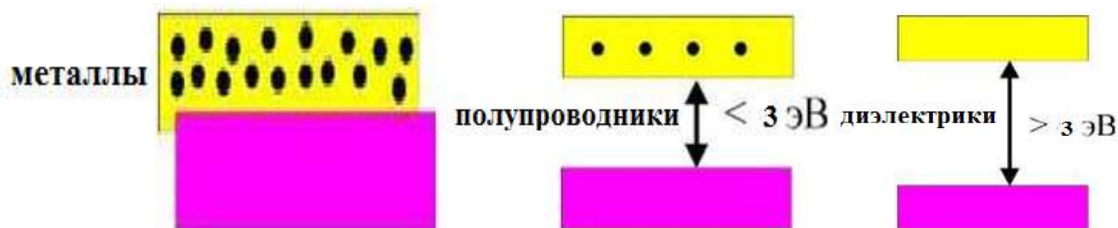
Рисунок 7 –Зонная теория принципиального отличия проводниковых материалов от диэлектриков и полупроводников
