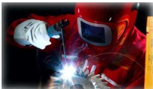
Рисунок 41- Дуговая сварка
