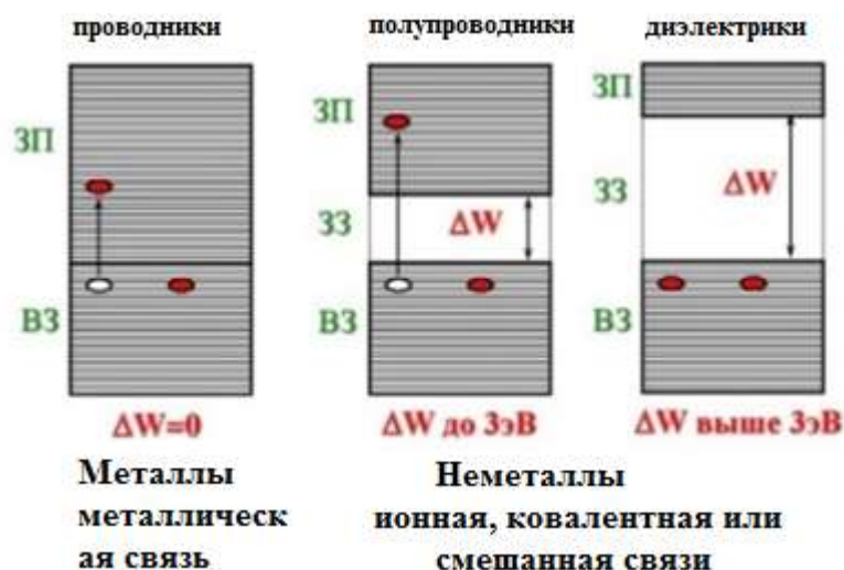
Рисунок 2-Зонная теория электротехнических материалов: ЗП-зона проводимости, ЗЗ - запрещаяющая зона, ВЗ-валентная зона.
