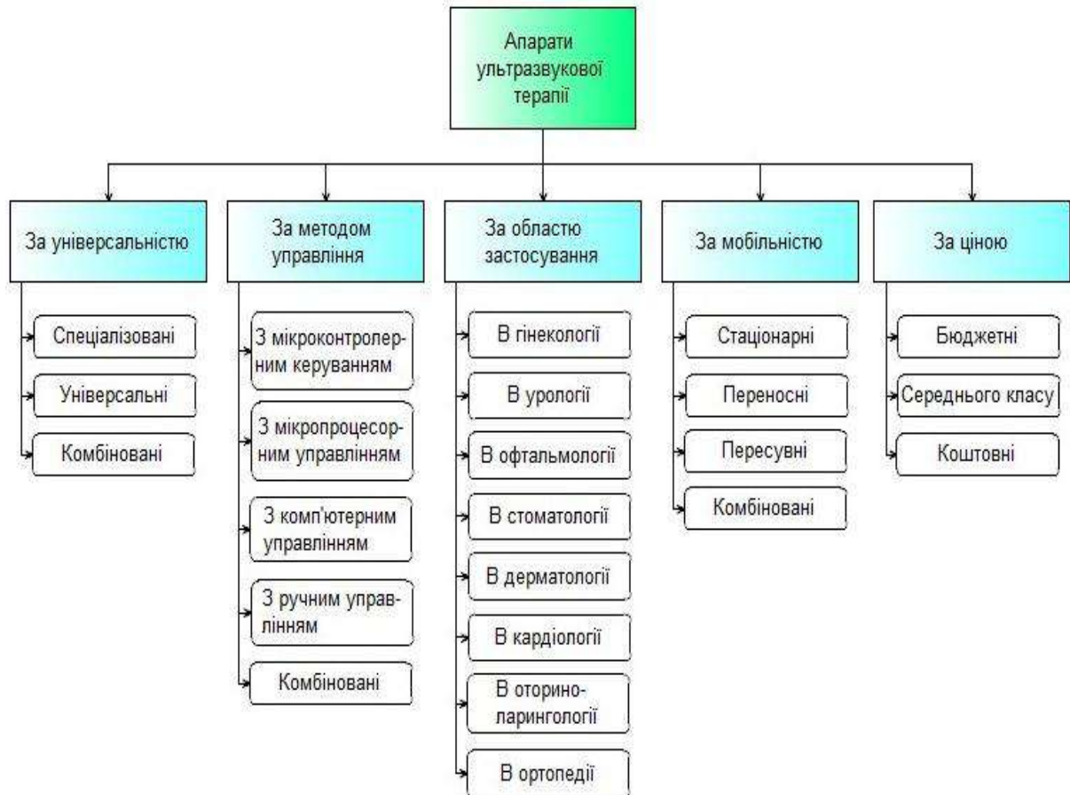
Рис. 2.19. Класифікація апаратів та систем ультразвукової терапії
