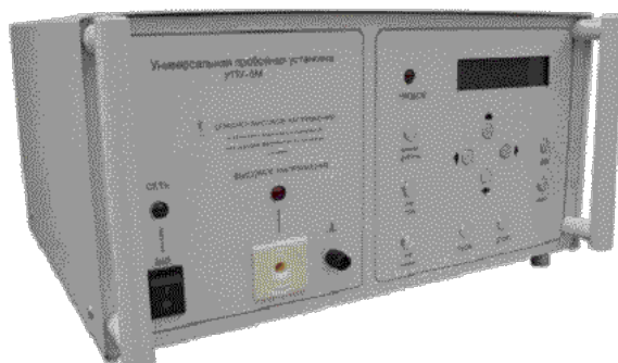
Рисунок 3.15- Универсальная пробойная установка УПУ-5М
