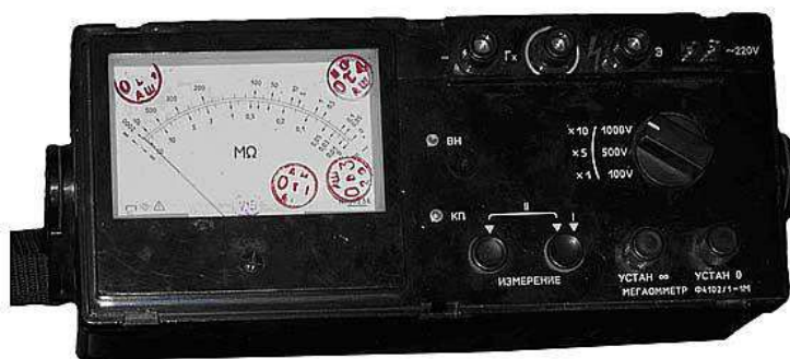
Рисунок-3.27- Мегаомметр Ф4102/1-1М
