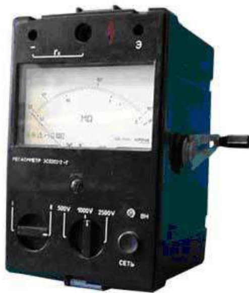
Рисунок 3.26- Мегаомметр ЭС0202-Г
