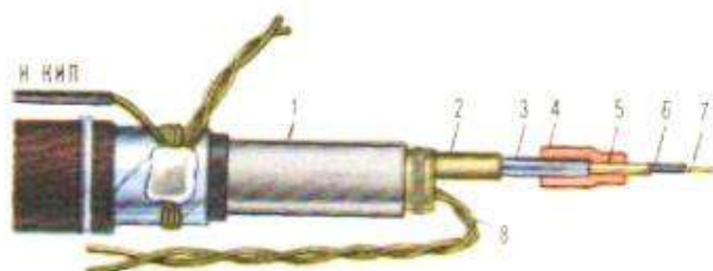
Рис. 2.24. Резка малогабаритного коаксиального кабеля типа 1,2 / 4,6 (показана одна коаксиальная и одна симметричная пара):
