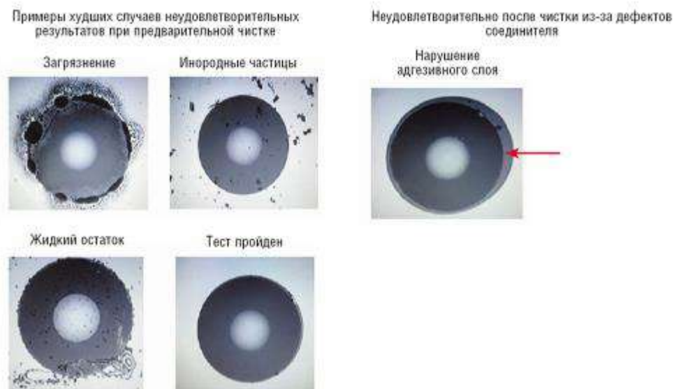
Рис.3.20. Загрязнение и дефекты торцевой поверхности
