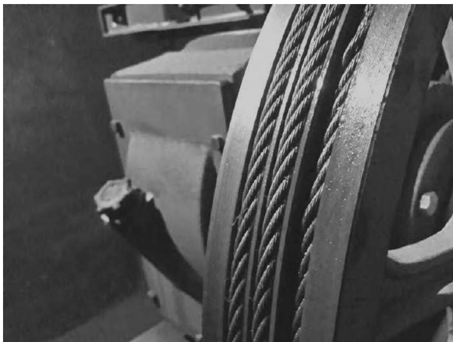
Рисунок 9.21 – Неравномерный износ ручьев канатоведущего шкива
