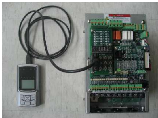
Рисунок 8.2 – Схема соединения устройства и ручного манипулятора
