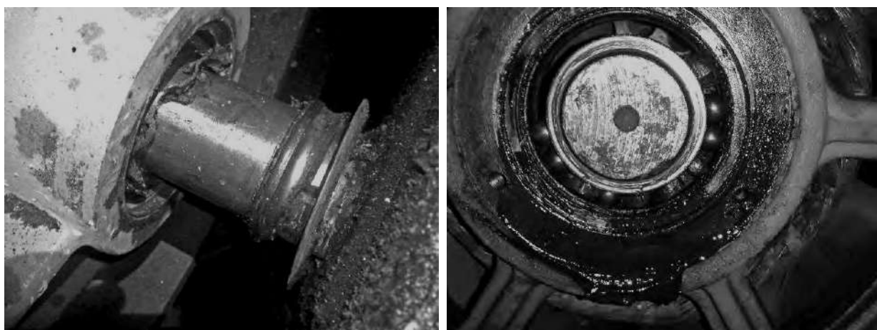
Рисунок 9.12 – Повреждения подшипниковых узлов электродвигателя
