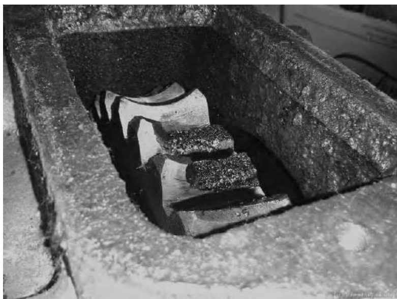
Рисунок 9.17 – Разрушение зацепления вследствие износа венца колеса
