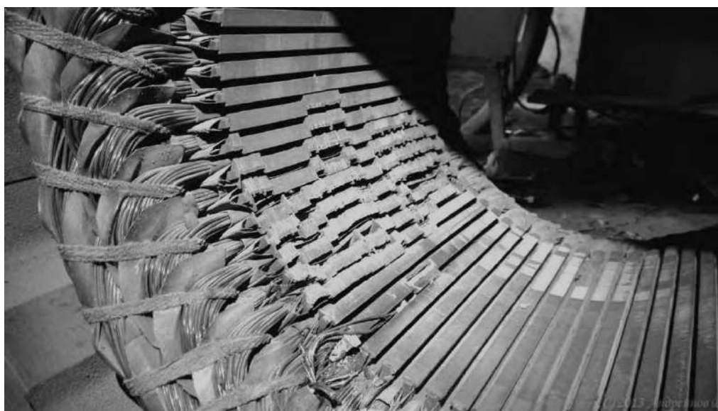
Рисунок 9.11 – Повреждения электродвигателя при задевании ротора о статор
