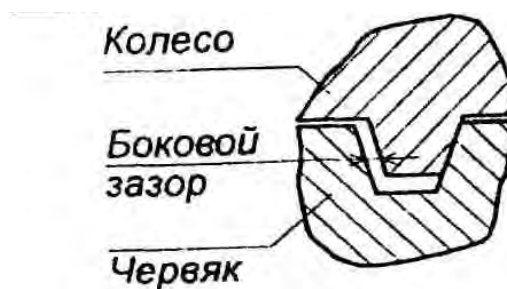
Рисунок 9.18 – Износ червячной пары редуктора
