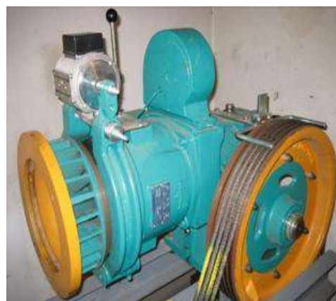
Рисунок 6.1 – Электропривод лифта
