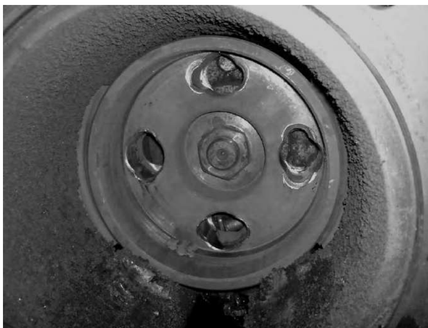
Рисунок 9.13 – Износ втулочно-пальцевой муфты
