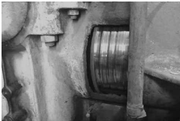
а – износ тормозной накладки; б – износ тормозной полумуфты Рисунок 9.15 – Повреждения тормоза лифта
