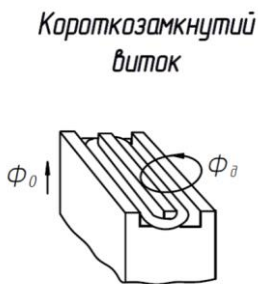
Рисунок 28 – До пояснення про короткозамкнений виток
