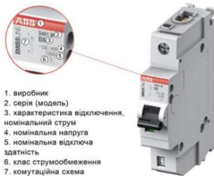
Рисунок 13 – Загальне розшифрування номінальних даних автоматичного вимикача
