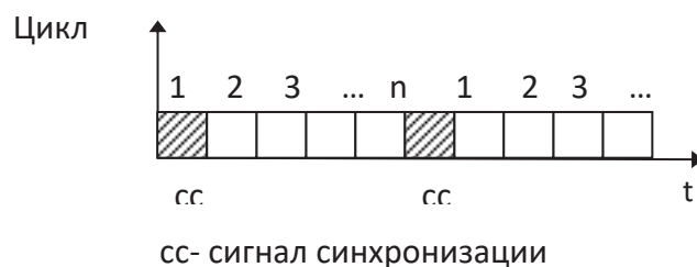
Рисунок 5.2.2 - Образование каналов ТЧ с временным разделением каналов
