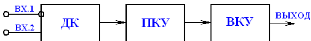
Рис. 2.5.4. - Структурная схема ОУ состоящая из трёх каскадов
