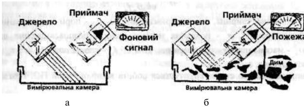
Рис. 2.3.12. Умовна схема чутливої камери оптичного димового ПС
