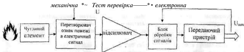
Рис. 2.1.1. Загальна схема будови сучасного дискретного пожежного сповіщувача
