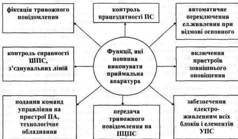
Рис. 3.1. Функції, що виконуються приймальною апаратурою УПС
