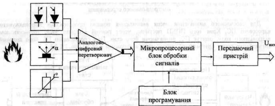
Рис. 2.1.4. Схема комбінованого пожежного сповіщувача
