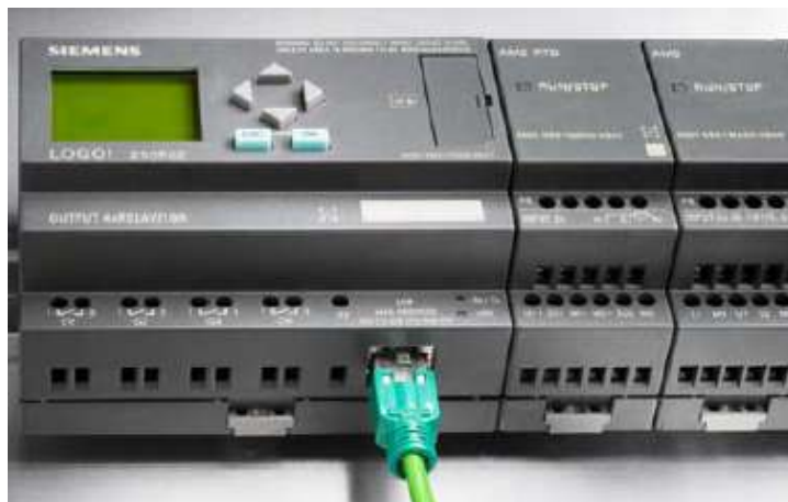
Рис. 1.27. Модуль LOGO! в версии 0BA7 с сетевым интерфейсом Ethernet и модулями расширения I/O
