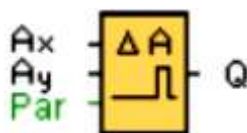
Рис. 5.42. Блок функции интервального реле (импульсный выход)
