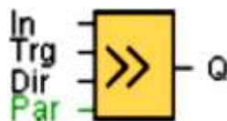
Рис. 5.77. Временная функция регистра сдвига
