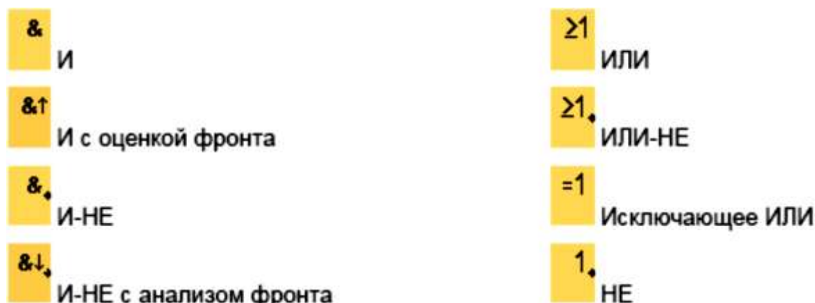
Рис. 5.1. Базовые логические функции
