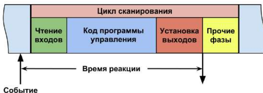
Рис. 1.3. Рабочий цикл ПЛК (PLC)
