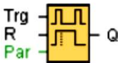
Рис. 5.27. Блок функции многофункционального выключателя)
