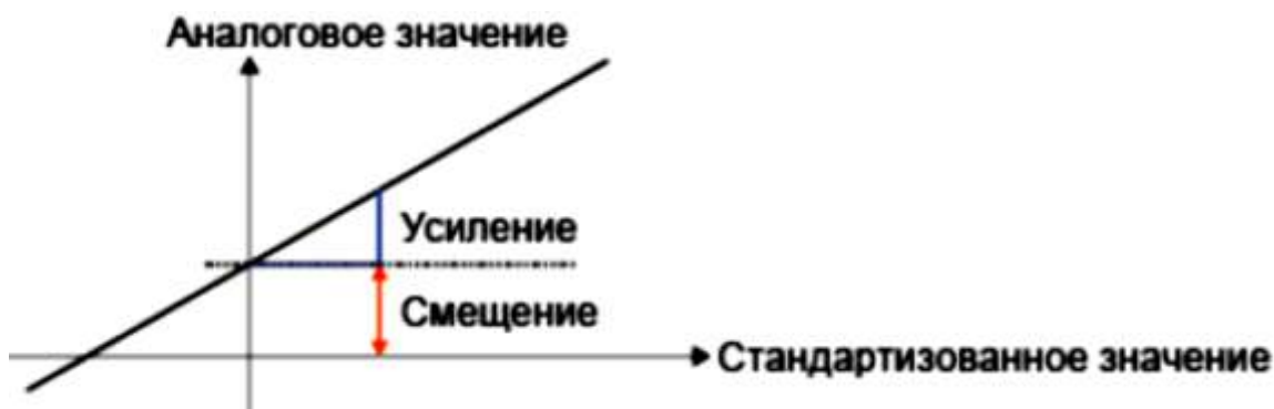
Рис. 5.55. Графическое отображение процесса усиления
