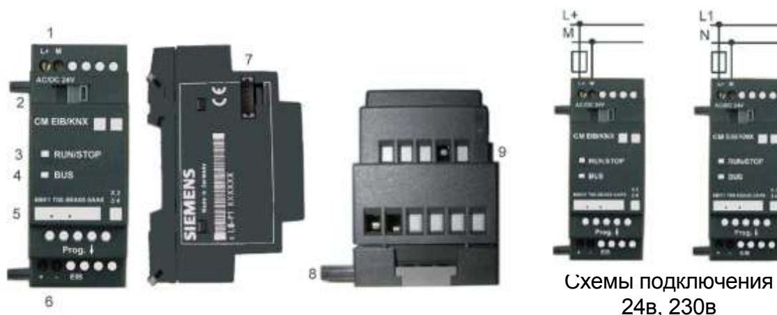
Рис. 1.17. Коммуникационные модули LOGO! CM EIB/KNX: 1 – источник питания; 2 – шинный ползок сопряжения с LOGO! 3 – RUN/STOP индикаторы подключения к LOGO! 4 – сетевой LED, EIB связь; 5 – метка для физического адреса; 6 – входы – EIB соединение; 7 – интерфейс расширения LOGO! 8 – механическое кодирование – штифт; 9 – кнопка программирования
