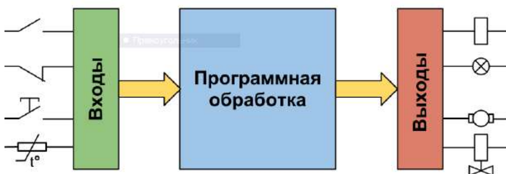
Рис. 1.2. Принцип функционирования логического контроллера
