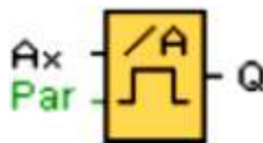
Рис. 5.36. Блок функции аналогового порогового выключателя
