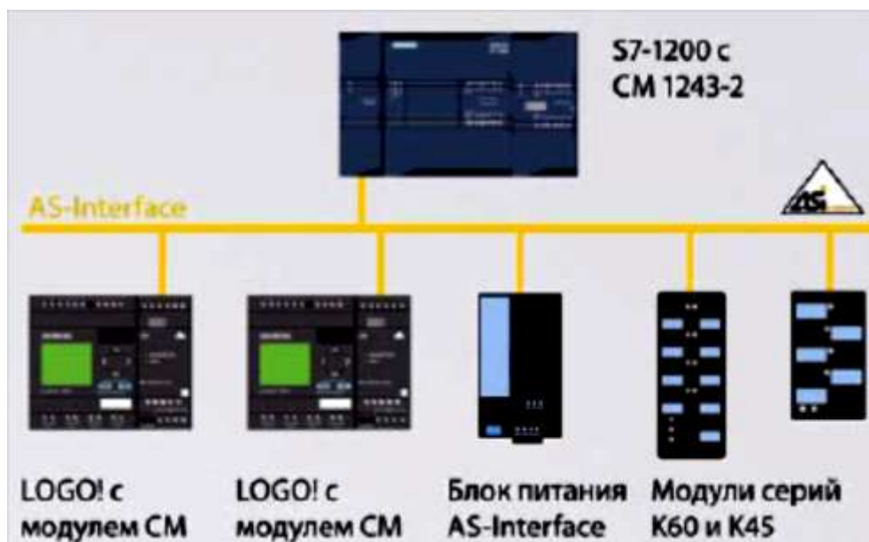
Рис. 1.25. Сеть на основе интерфейса AS-i с ведущим Master PLC S7-1200
