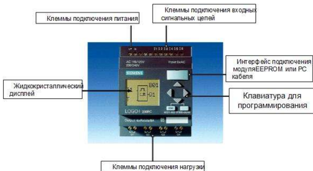
Рис. 1.10. Дизайн аппаратного интерфейса модуля ПЛК LOGO!
