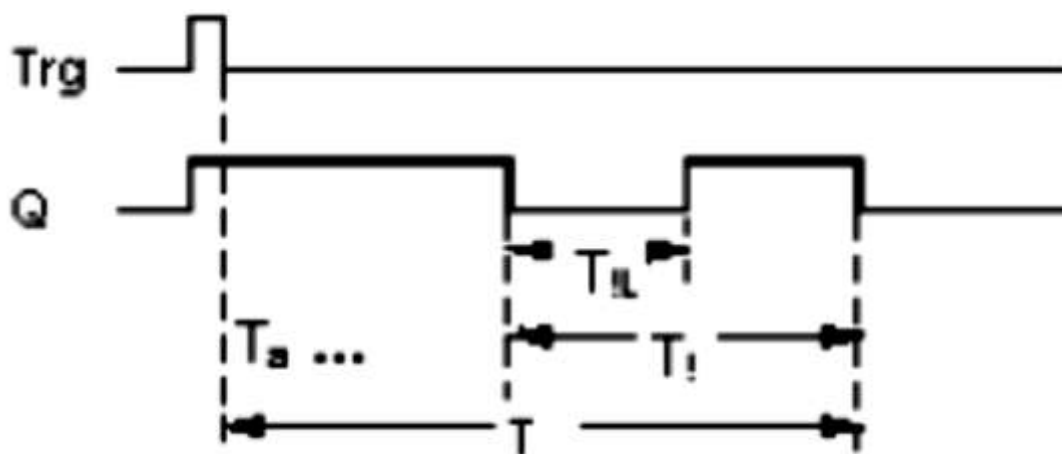
Рис. 5.25. Временная диаграмма задержки включения
