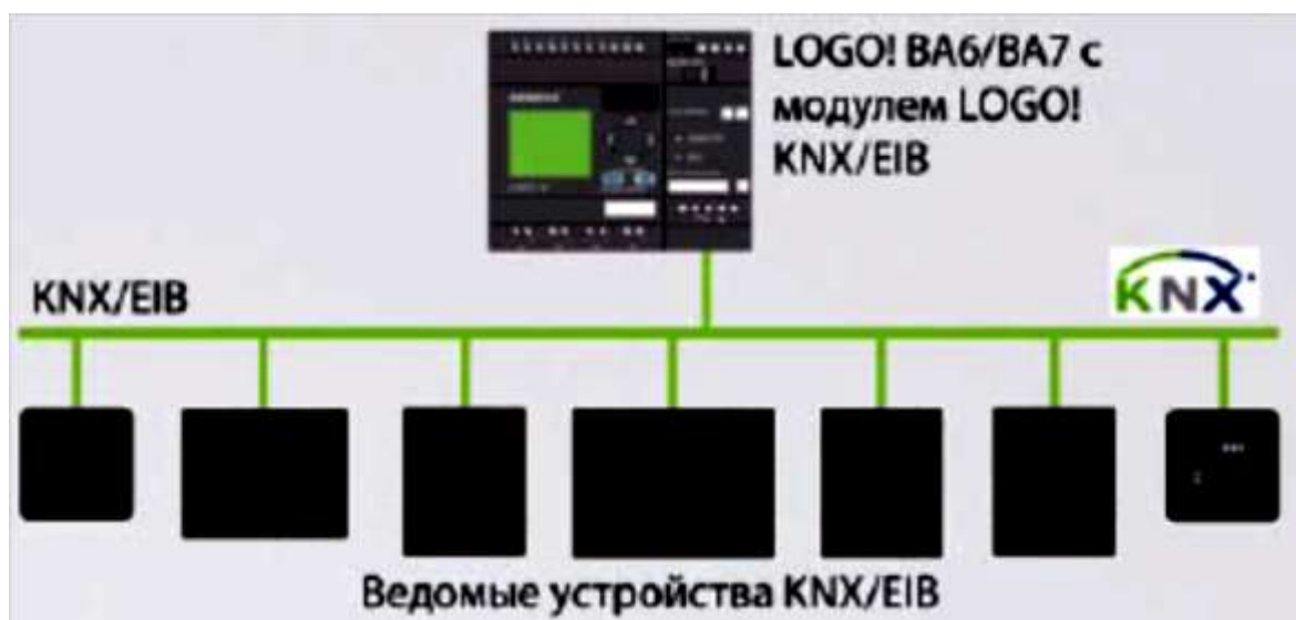
Рис. 1.26. Пример структуры сети KNX/EIB
