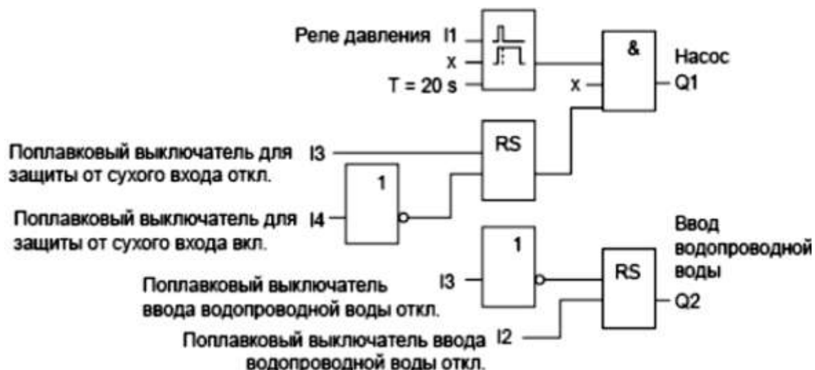
Рис. 4.8. Блок-схема программы на языке ФБД
