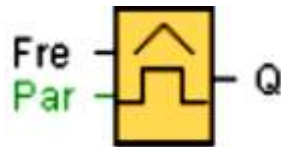
Рис. 5.34. Блок функции порогового выключателя
