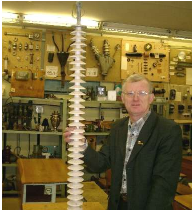
Рисунок 4 - Предохранитель стреляющий ПСН – 35 и изолятор силиконовый на 110 кВ
