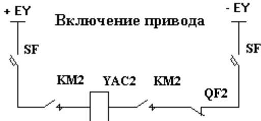
Рисунок 20 - Схема автоматического включения резерва (АВР)
