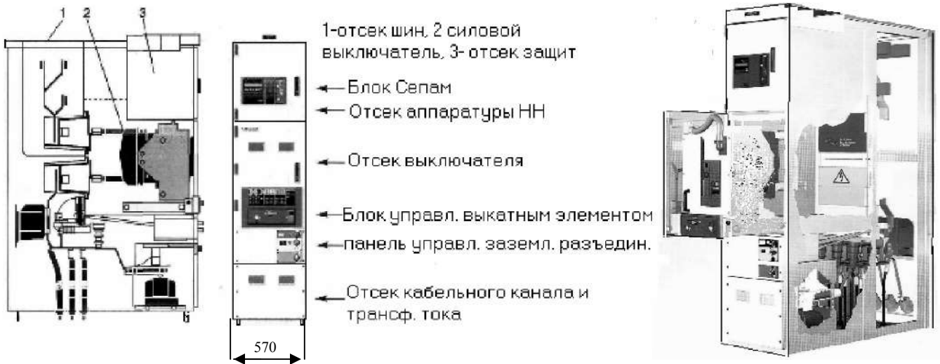
Рисунок 24 - Устройство и общий вид КРУ MS-set на напряжение 6 - 10 кВ
