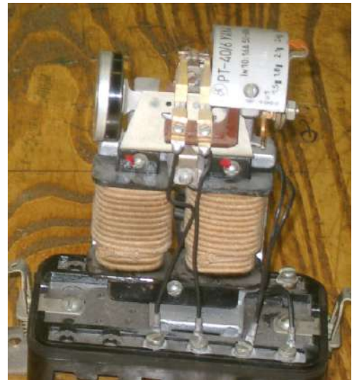
Рисунок 6 – Первичное и вторичное реле, прямое воздействие на привод выключателя
