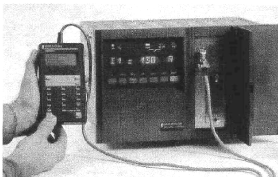
Рисунок 12 – Снятие характеристик с помощью выносного пультa
