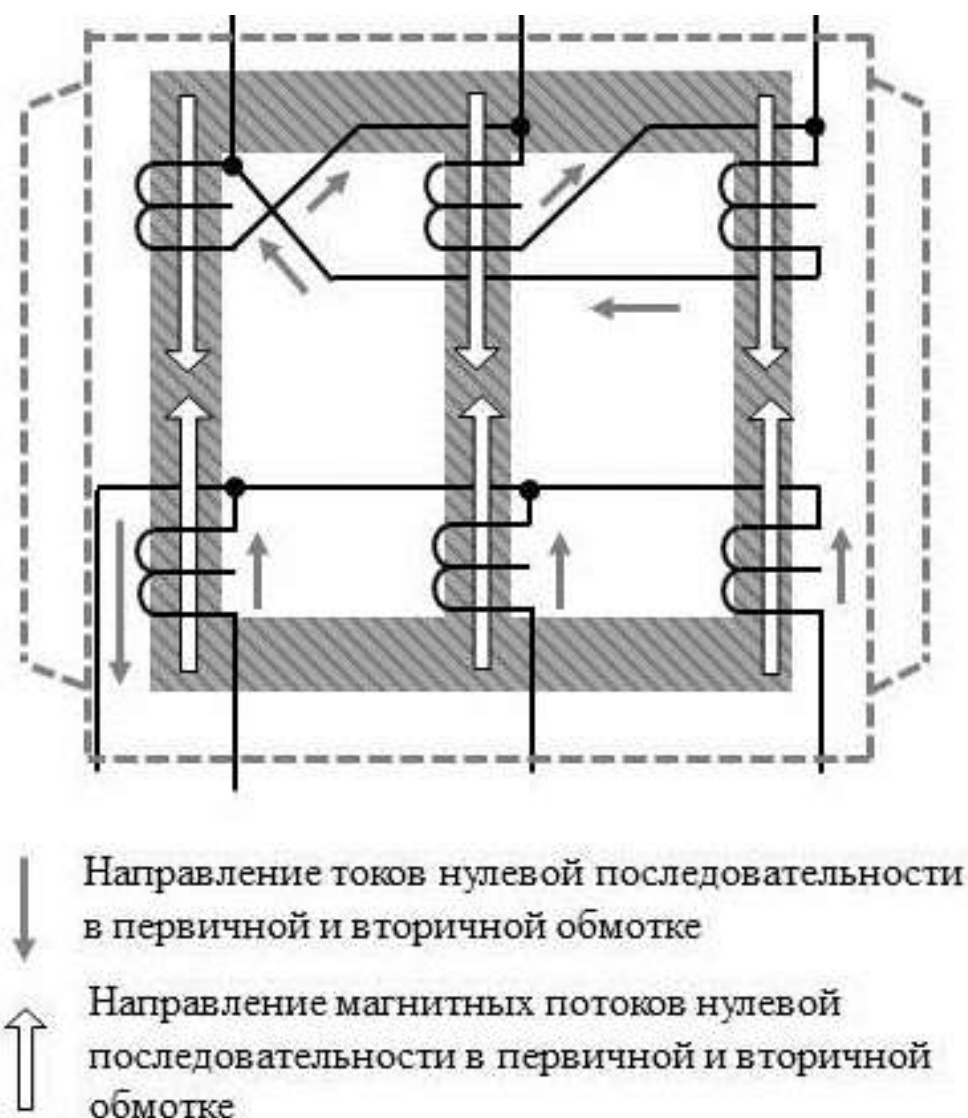
Рисунок 4.3 – Направление нулевых токов и магнитных потоков нулевой последовательности при схеме соединения «треугольник – звезда с нулём»
