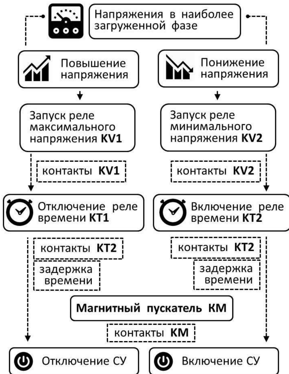
Рисунок 4.12 – Алгоритм работы автоматического управления симметрирующим устройством в функции напряжения
