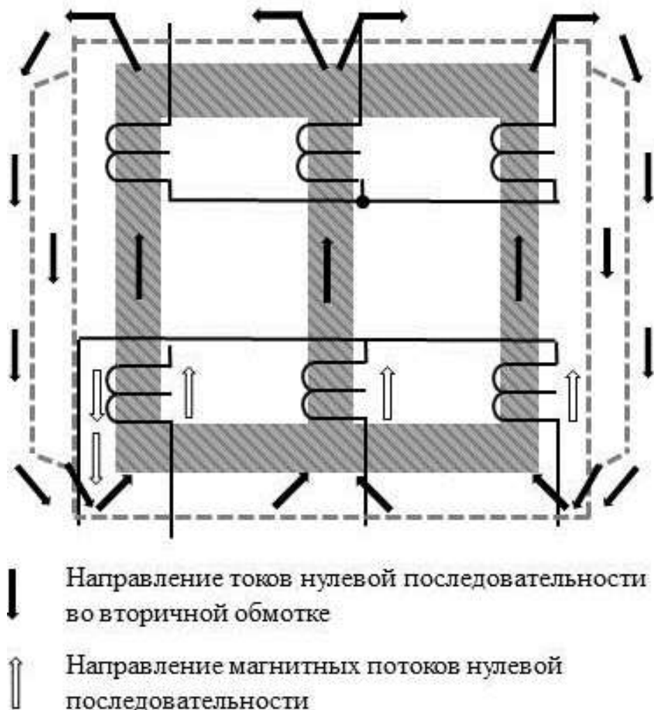
Рисунок 4.1 – Направление нулевых токов и магнитных потоков нулевой последовательности при схеме соединения «звезда-звезда с нулем»
