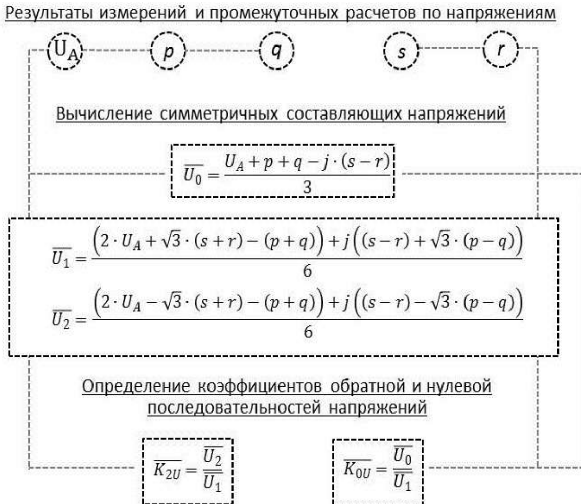
Рисунок 2.8 – Блок-схема определения коэффициентов обратной и нулевой последовательностей напряжений
