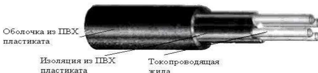
Рисунок 19 – Кабель силовой с пластмассовой изоляцией без защитного покрова
