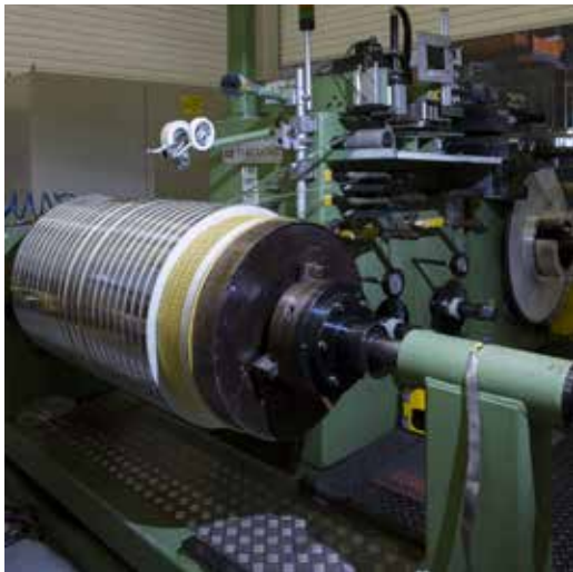
Обмотка ВН, изготавливаемая из металлической ленты
