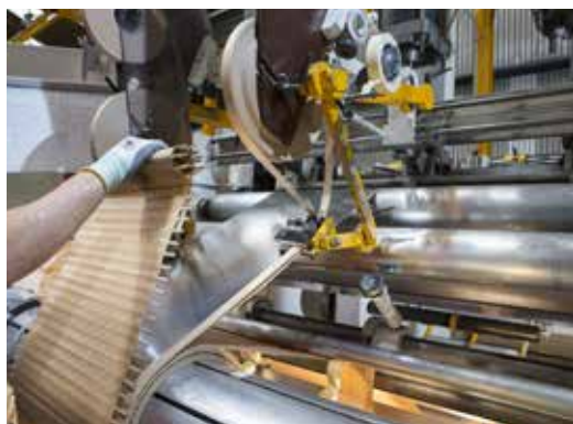
Обмотка НН, изготавливаемая из металлической фольги
