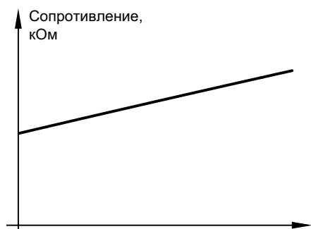
Типовой график датчика PT100
