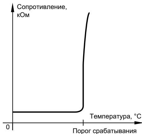
Типовой график датчика PTC
