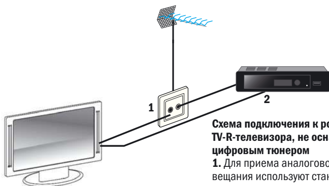
Схема подключения телевизора и радиосистемы к розетке TV-R
