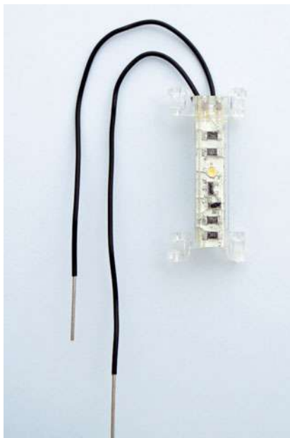
Светодиодный элемент подсветки с гибкими соединительными проводниками
