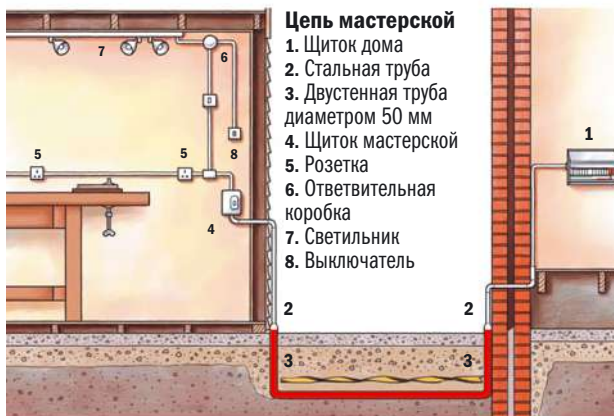
Подводка кабеля к мастерской
