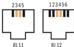
Нумерация контактов телефонных розеток. Центральные контакты отмечены красным цветом
