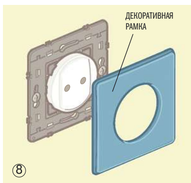
Монтаж розетки скрытой установки на кирпичную или бетонную стену
