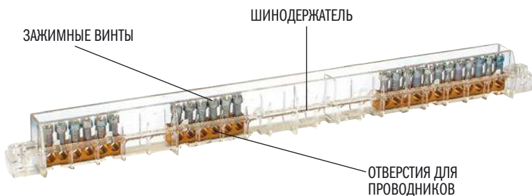
Шины N и PE в шинодержателе
