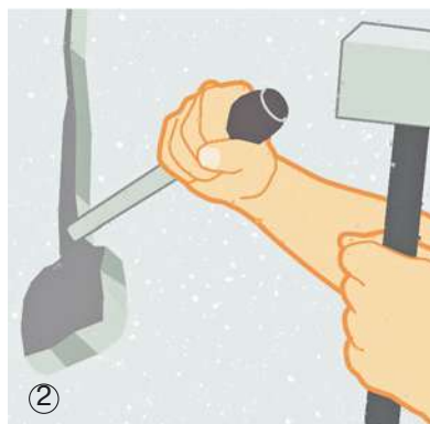
Монтаж розетки скрытой установки на кирпичную или бетонную стену
