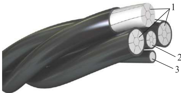
Рис. 51.12. Конструкция проводов типа СИП: 1 – фазные провода; 2 – нулевой провод; 3 – несущий провод
