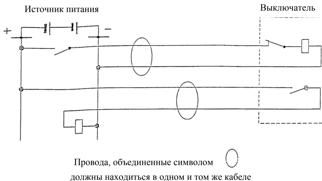
Рис.6. Цепи постоянного тока в контрольных кабелях.
