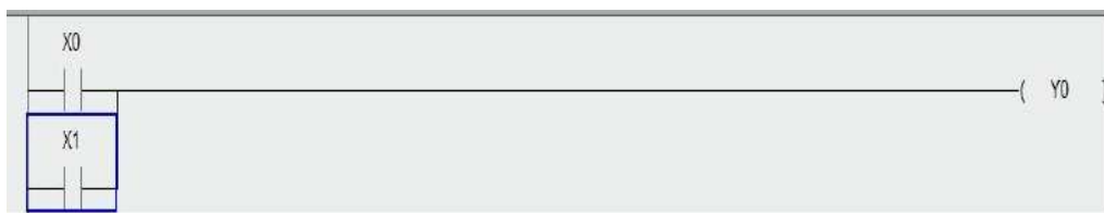
Рисунок 4.13 – Входы 0, 1 и выход 0 на лестничной диаграмме.
