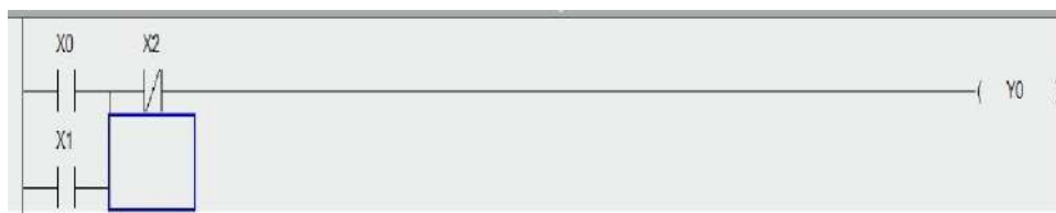
Рисунок 4.14 – Входы 1..3, выход 0 на лестничной диаграмме.
