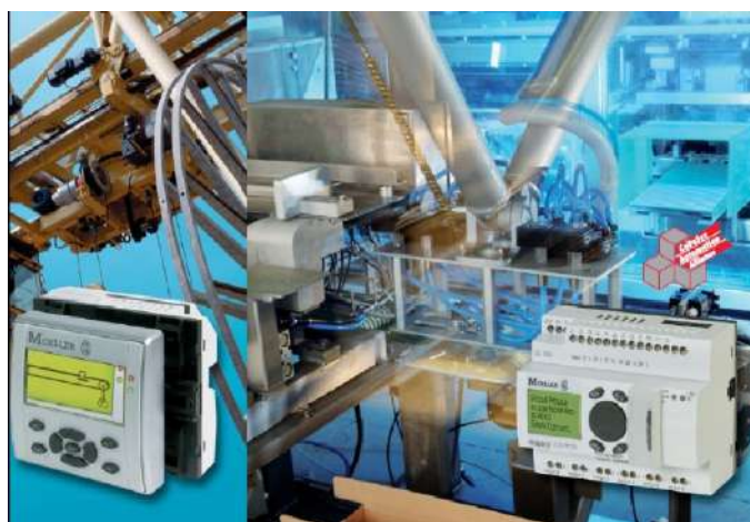
Рисунок 3.2 – Внешний вид реле EASY, панель оператора MFD Titan и Easy Control в технологическом процессе.
