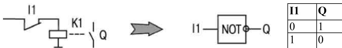
Рисунок 3.34– Электрическая принципиальная схема функции «НЕ»
