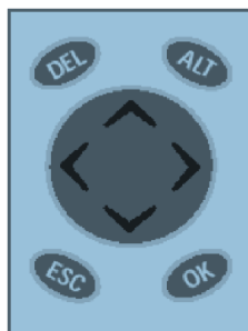
Рисунок 3.7 – Операционные кнопки реле.
