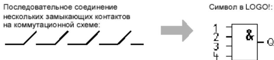
Рисунок 3.68 – Представление функции «И» в LOGO! и на коммутационной схеме.
