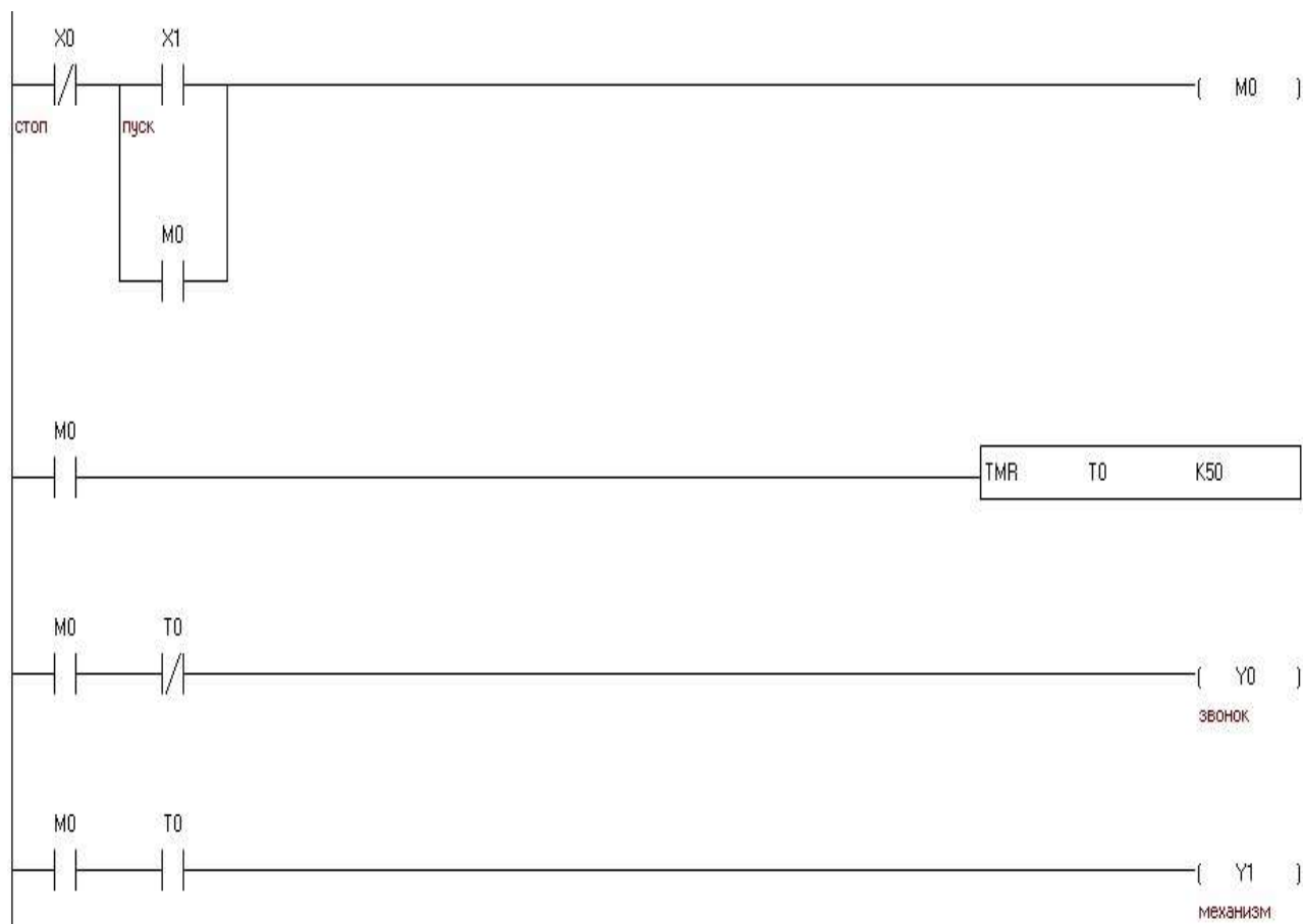
Рисунок 4.24 – Пускосигнальное звено на языке LD.
