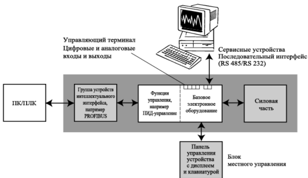
Рис. 2.43. Базовая комплектация средств связи (преобразователя частоты)
