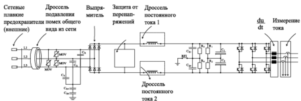
Рис. 4.16. Преобразователи частоты и меры подавления ВЧ-помех
