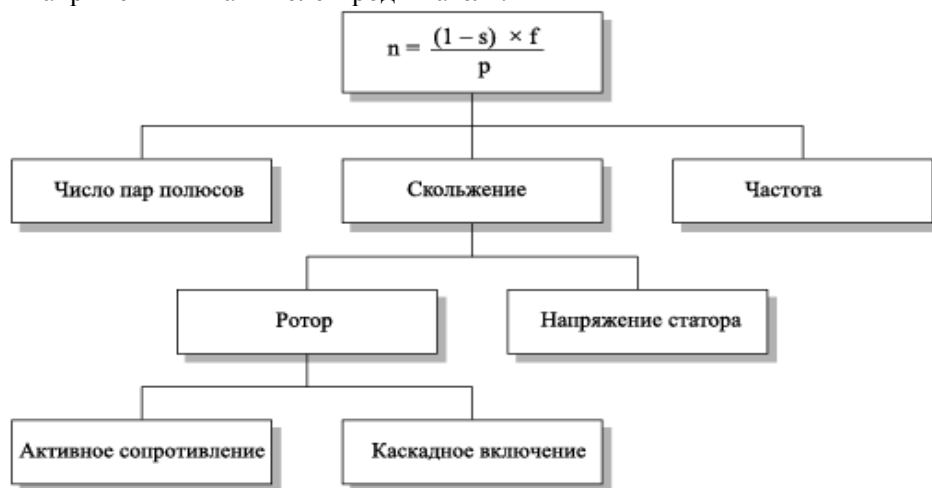
Рис. 1.17 Различные возможности изменения скорости электродвигателя
