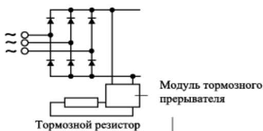
Рис. 3.19. Включение тормозного модуля и тормозного резистора
