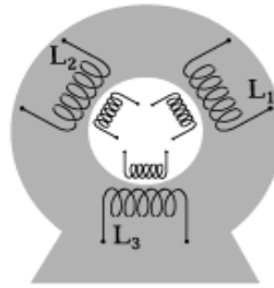
Рис. 1.14а Расположение обмоток статора и ротора
