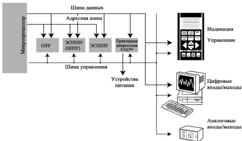
Рис. 2.41. Типовой чип преобразователя частоты
