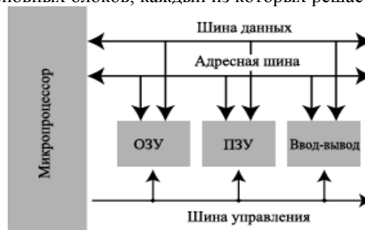
Рис. 2.40. Принципиальная схема микрокомпьютера
