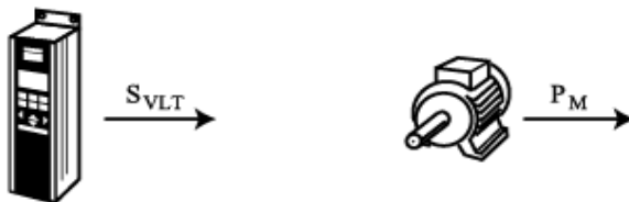
Рис. 3.13 Выбор преобразователя частоты по выходной мощности на валу
