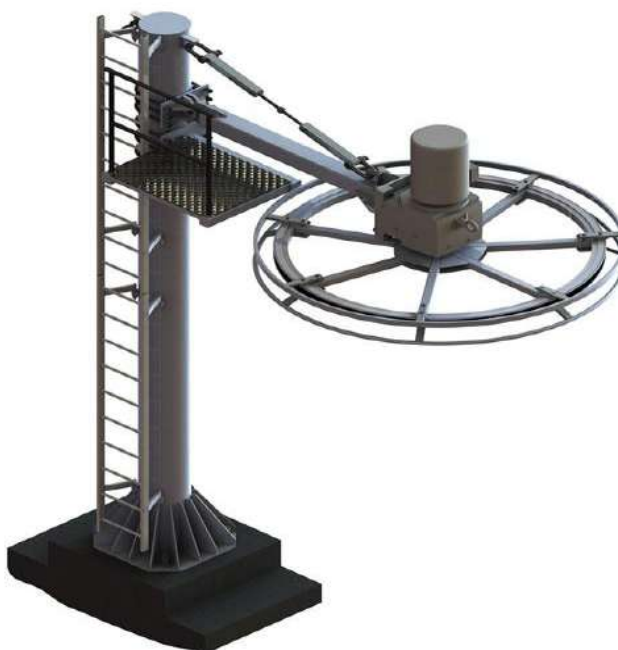
Рис. 11. Приводная станция канатной дороги БКД типа L
