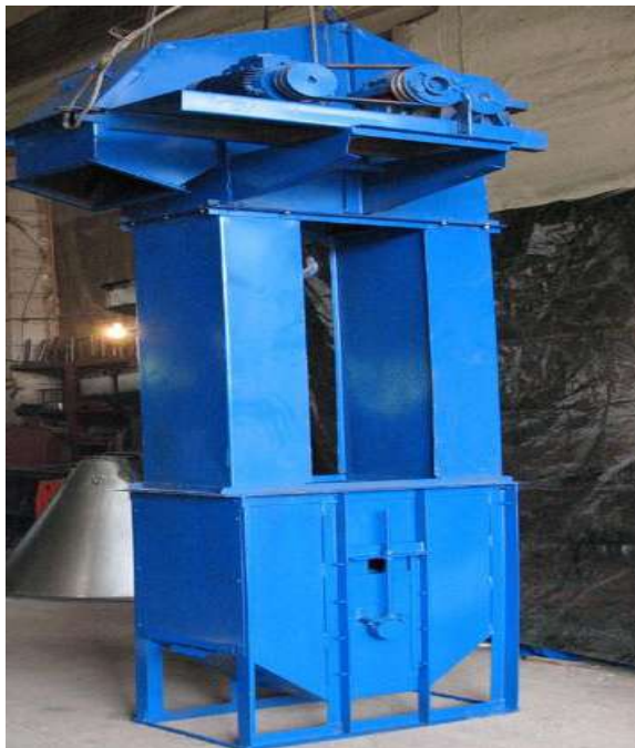
Рис. 7. Транспортирующие машины: а – вертикальный ленточный ковшовый элеватор; б – винтовой конвейер
