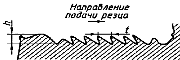
Рис. 63. Вид профиля поверхности вала, подготовленной к напылению (глубина h = 0,7\text{--}0,8 мм; шаг t = 1,6\text{--}2,0 мм)
