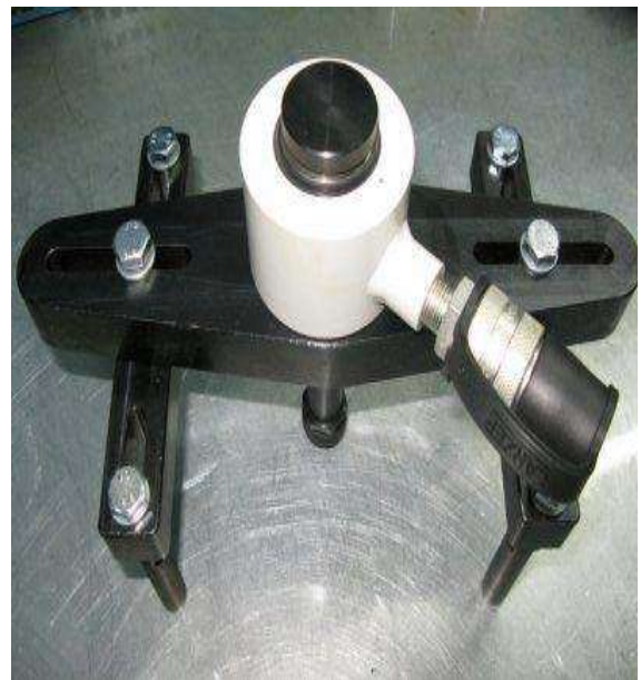
Рис. П.2. Схема конструкции съемника с траверсой: 1 – траверса; 2 – деталь; 3 – раздвижные трубы; 4 – болт
