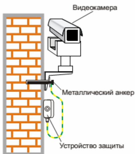
Рис.1.3. Установка оборудования на кирпичной стене здания.
