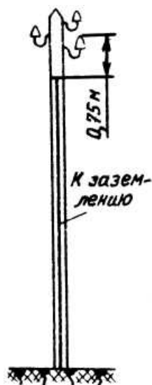
Рис. 23. Защитный промежуток на опоре ВЛ напряжением 3–20 кВ с заземляющим спуском
