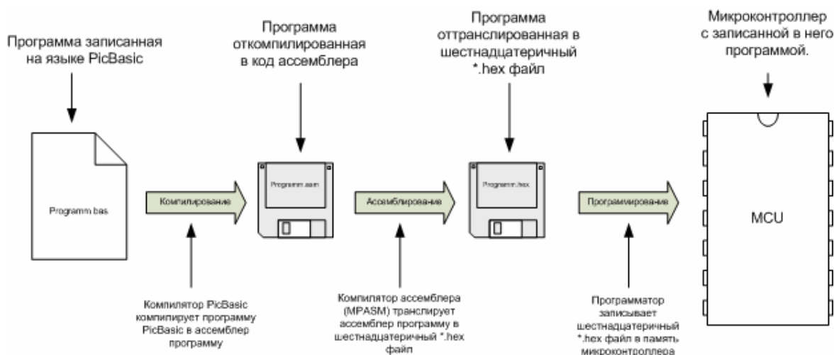
Рис.1. Процесс преобразования исходного текста программы в конечный шестнадцатеричный .hex файл и запись его в микроконтроллер.
