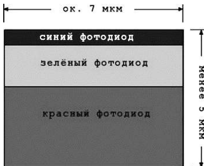
Рис. 9.13. Принцип получения цветного изображения в матрицах с полноцветными пикселями
