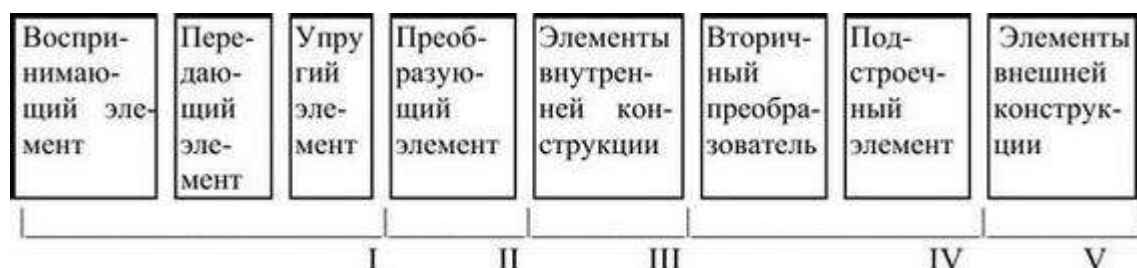
Рис. 4.4. Структурная схема интеграции элементов тензорезистивного преобразователя давления
