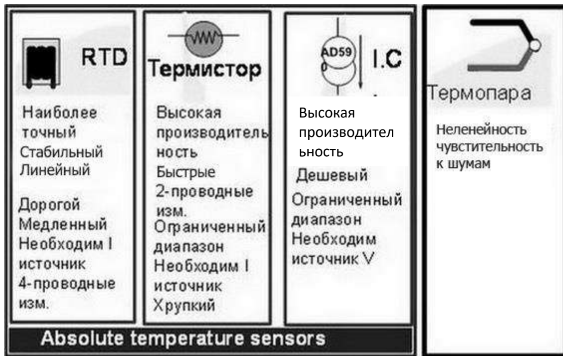
Рис. 5.30. Оценка использования термодатчиков в конкретной ситуации
