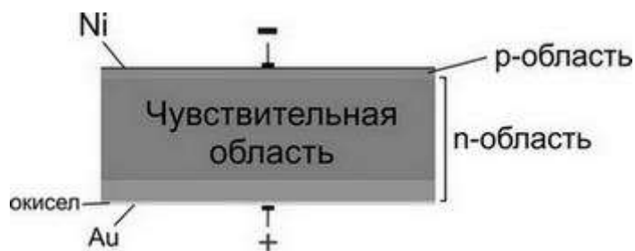
Рис. 10.9. Поверхностно-барьерный детектор
