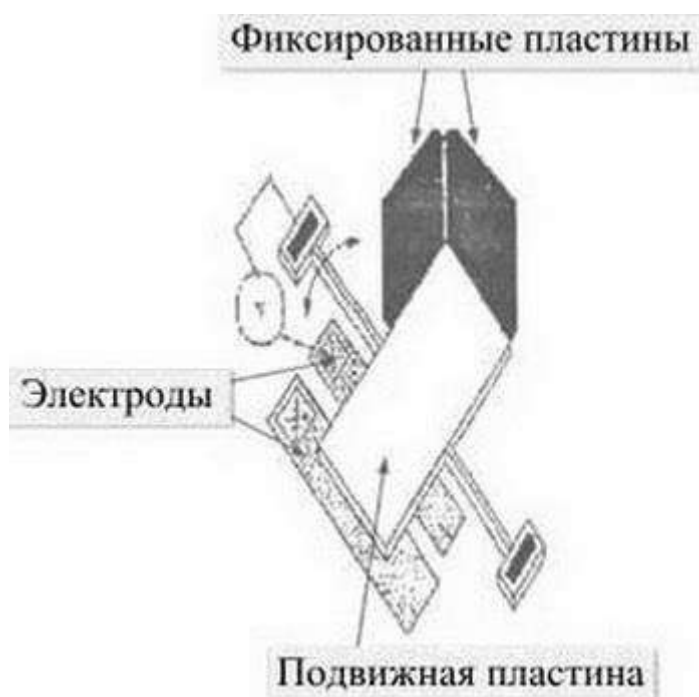
Рис. 11.10. Схематическое изображение углового кубического отражателя
