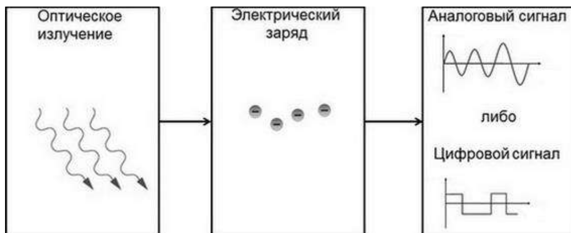
Рис. 9.1. Техническая идеология датчика изображения
