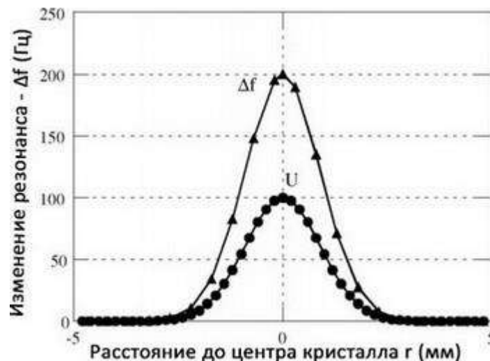
Рис. 13.23. Изменения резонансной частоты (с нагрузкой и без нее)
