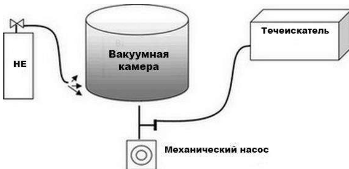
Рис. 13.5. Вакуумный метод поиска течей
