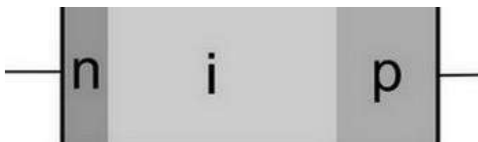
Рис. 10.10. Диффузионно-дрейфовый p-i-n -диод
