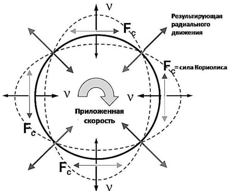
Рис. 6.17. Режим создания бегущей волны вершины эллипса за счет пьезоэффекта
