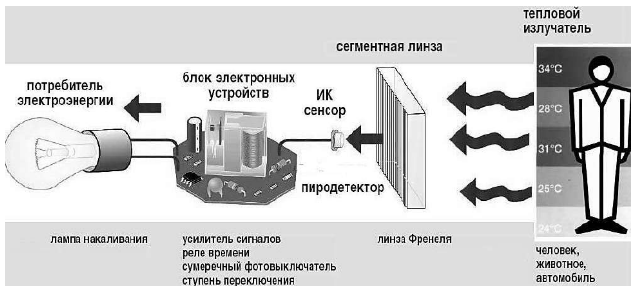
Рис. 5.43. Реальная схема с использованием пиродатчика
