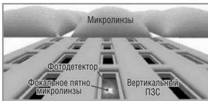
Рис. 3.14. Микролинзы
