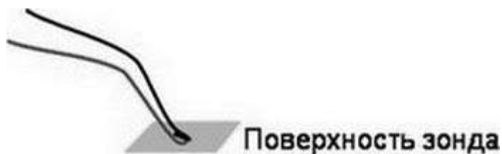
Рис. 5.28. Тепловой контакт как типичный источник погрешности
