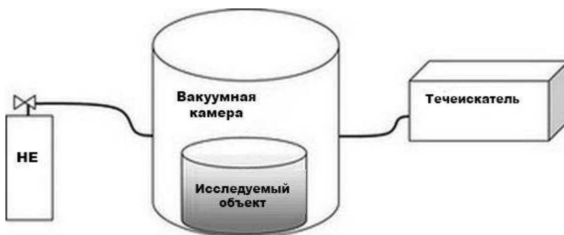
Рис. 13.6. Глубоковакуумный метод поиска течей
