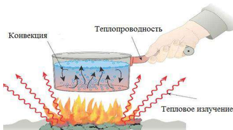
Рис. 3.1. Распространение теплоты в пространстве
