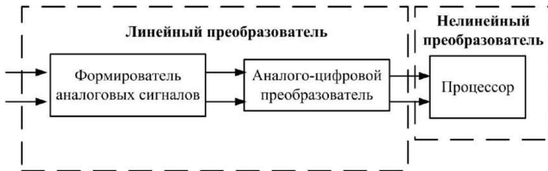
Рис. 3.6. Обобщенная структурная схема цифрового измерительного органа
