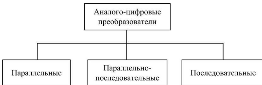
Рис. 3.8. Некоторые виды аналого-цифровых преобразователей
