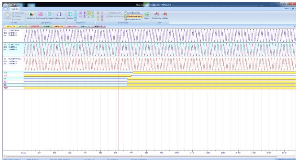
Рисунок 7.9 – Осциллограмма срабатывания устройства автоматического повторного включения
