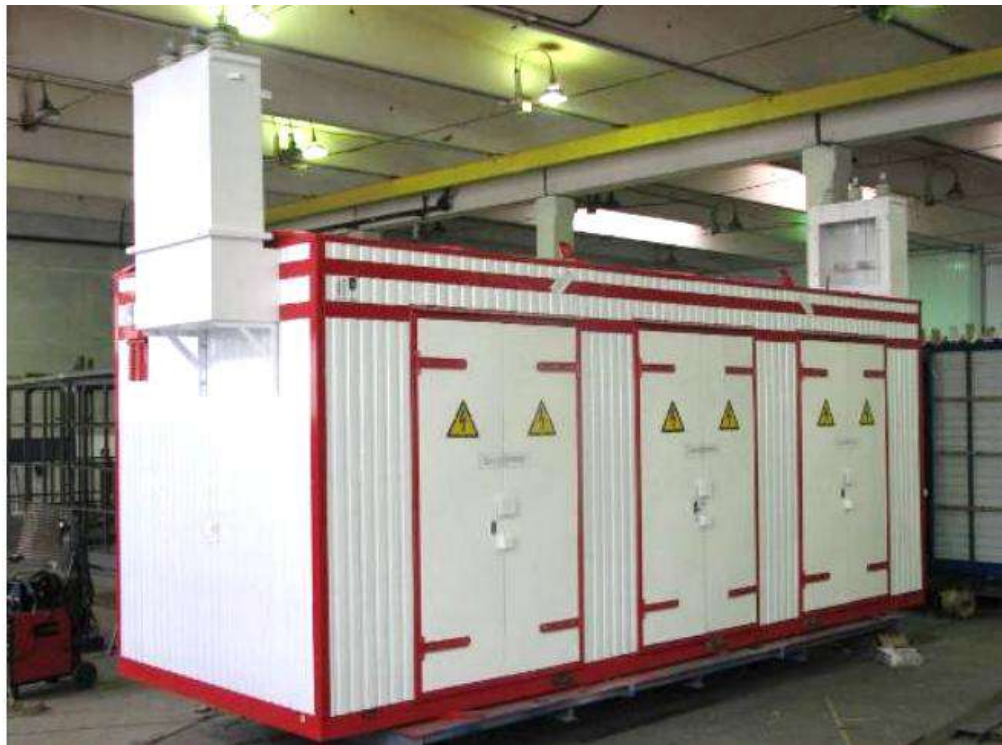
Рис. 2.6. Установка ПАРН в блок-контейнере
