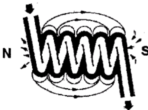
Катушка усиливает магнитное поле
