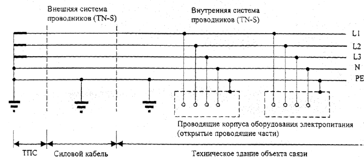
Рисунок 16 - система TN-S заземления электропитающей сети переменного тока для аппаратуры ВОЛП
