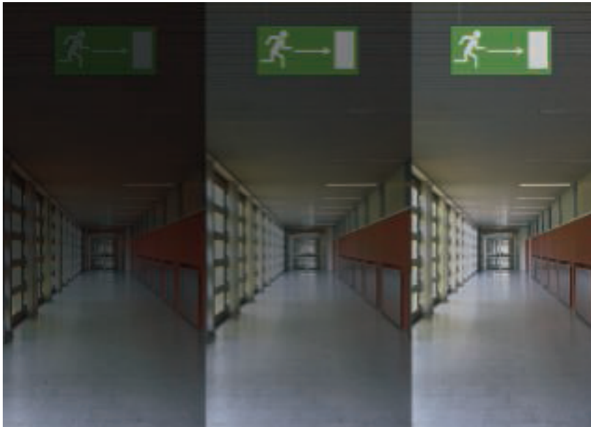
Характеристики кабелей, используемых на случай пожара: с изоляцией из поливинилхлорида, с пониженным дымовыделением, безгалогеновые (слева)
