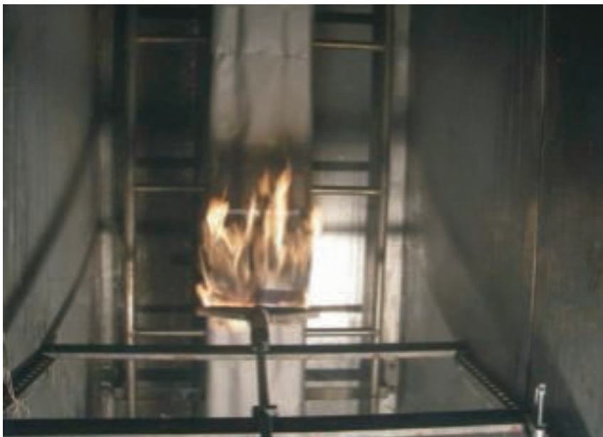
Огнестойкий бандаж подвергается воздействию пламени
