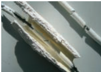
Кабели с повышенной живучестью с изолирующим слоем из золы.
