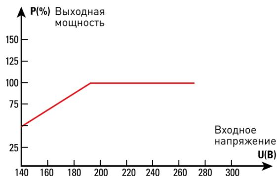
Если входное напряжение находится в диапазоне 190-250 В, стабилизатор может обеспечивать 100% максимальной выходной мощности, указанной в спецификации. Максимальная выходная мощность будет изменяться в соответствии с кривой на рисунке.
