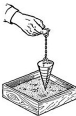
Рис.34. Проверка подвижности бетона эталонным конусом
