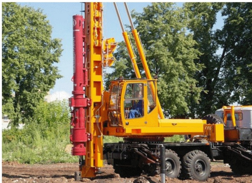
Рис.27. Бурение скважин под опоры бурильно-сваебойной машины БМ-811
