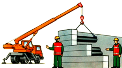
Рис.44. Передача сигналов в ограниченной зоне видимости
