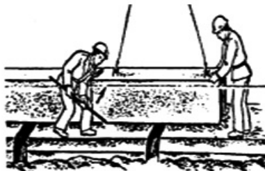
Рис.19. Выверка блока
