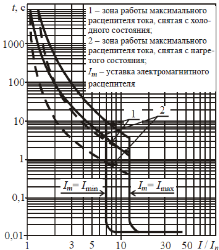
Рисунок 7.4 – Времятоковые характеристики выключателей ВА57Ф35 на токи 63 и 80 А: I_n – номинальный ток выключателя
