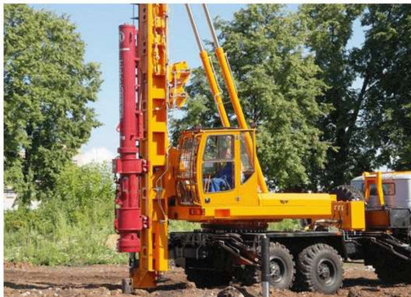
Рис.27. Бурение скважин под опоры бурово-сваебойной машины БМ-811
