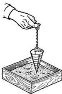
Рис.34. Проверка подвижности бетона эталонным конусом
