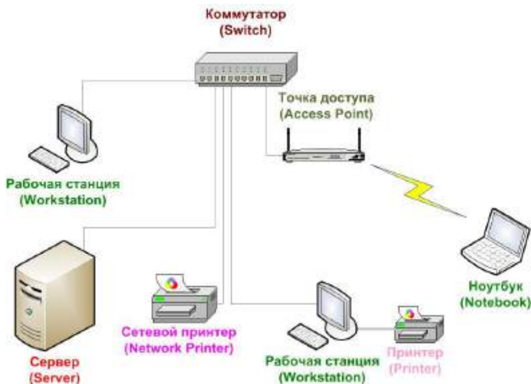
Рис. 1. Структура простейшей локальной компьютерной сети
