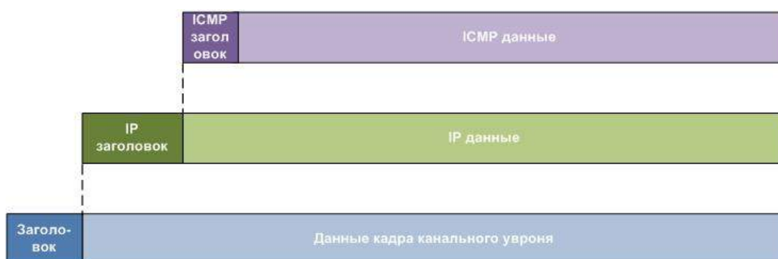
Рис. 103. Схема инкапсуляции сообщений ICMP
