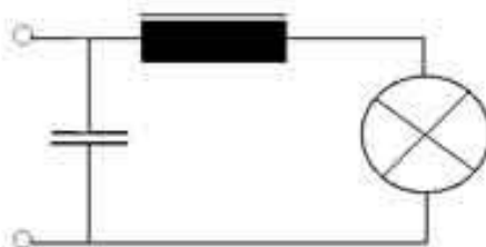
Рис. 4.10. Схема подключения лампы ДРЛ
