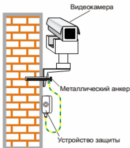
Рисунок 17. Защита оборудования установленного на стене здания.
