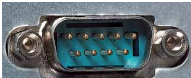
Рис. 10. 9-контактный последовательный кабель RS-232
