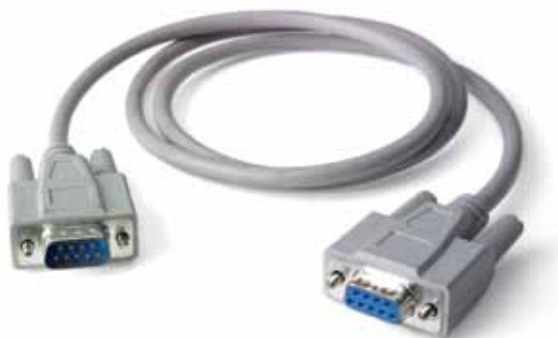
Рис. 10. 9-контактный последовательный кабель RS-232
