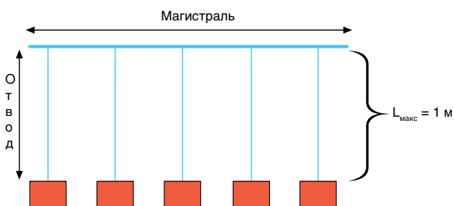
Рис. 23. Сеть с топологией «шина» («шлейф»)
