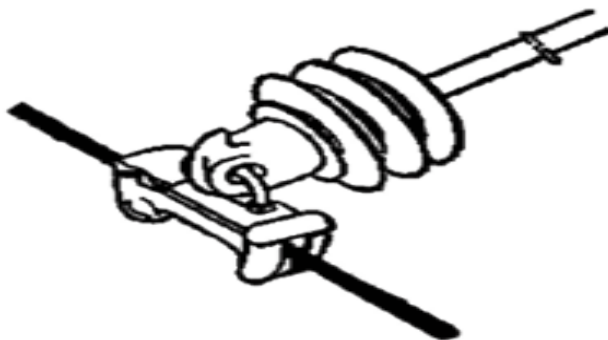
Конструкція дугогасного затиску, розробленого у Фінляндії
