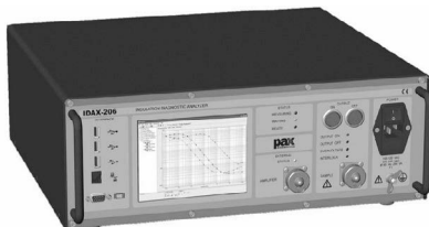
Рис. 11. Диагностика изоляции трансформаторов
