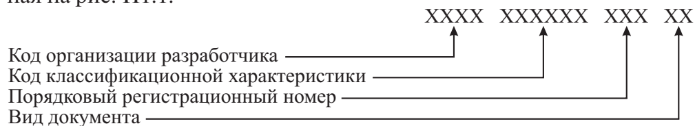
Рис. П1.1. Структура обозначения графических и текстовых документов проектов
